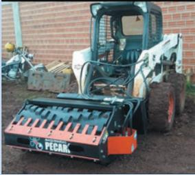
Adquirimos un nuevo vibrcompactador compatible con la minicargadora Bobcat, para trabajos de compactación y reparación de suelos, bacheos y otros trabajos de obras públicas.
